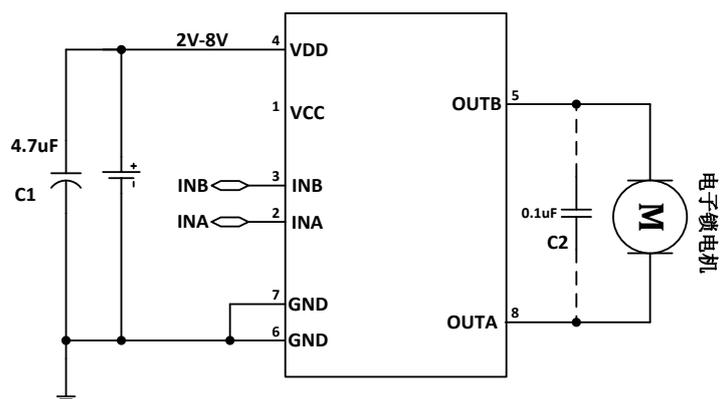
图3 MX08L 电子锁典型应用线路图
