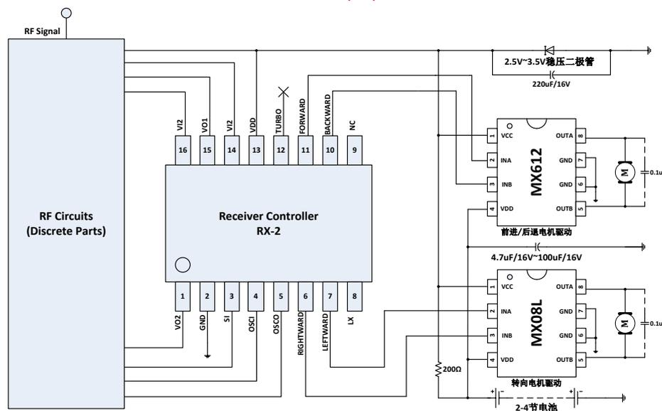
图 2 2-4 节电池供电玩具遥控车马达驱动应用线路图
