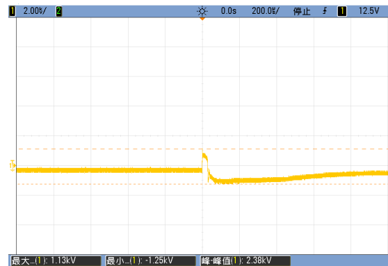
输出端电压波形(差模 1.13KV)
