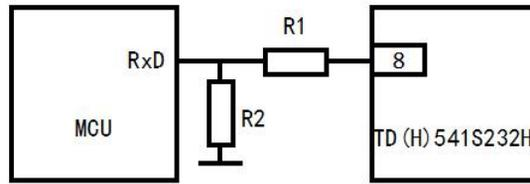
图 10. 匹配单片机系统接法
