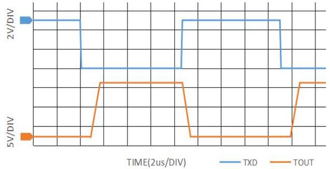
图6. 120kbps 的数据传输 ( $V_{CC}=5V, R_L=3k\Omega$ )
