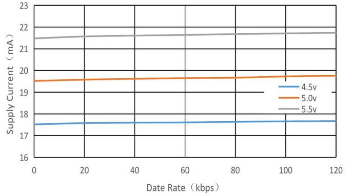
图4. 工作电流与通讯速率的关系
