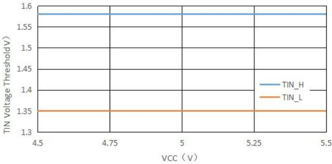
图5. TIN 电压阈值与VCC的关系
