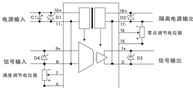
图 4 零点及满度调节电路
