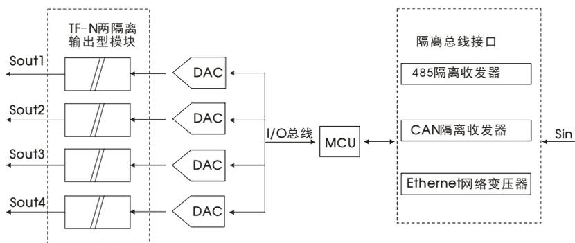
图 3 DCS 系统 AO 板卡隔离应用示意图
