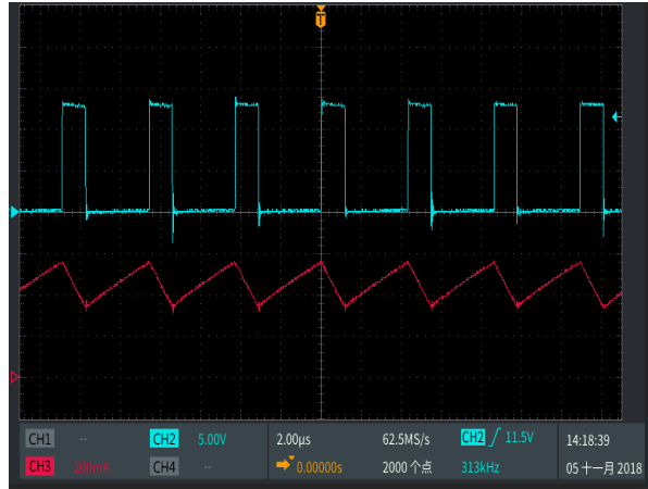
SW 脚与电感电流工作波形
