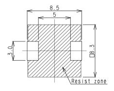
スクリーンマスク厚は0.10mmを推奨致します。 Screen mask thickness is recommended 0.10mm.
