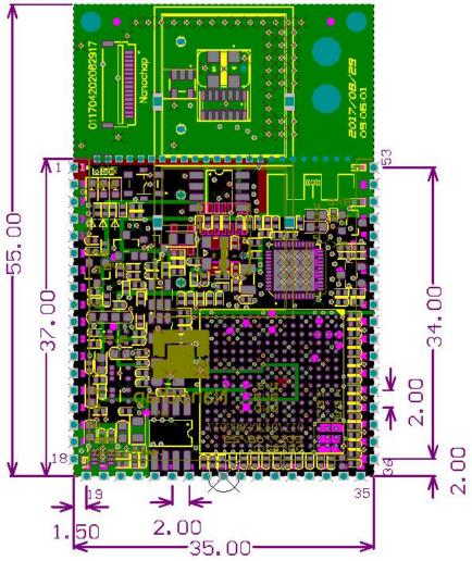
具体尺寸如上图所示,单位均为毫米,模组左边有 18 个邮票孔连接,下方有 17 个邮票 孔连接,右边有 18 个邮票孔连接。
