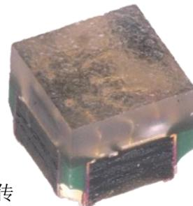
数据协议采用单极性归零码的通讯方式, 像素点在上电复位以后, DI 端接收从控制器传输过来的数据, 首先送过来的 48bit 数据被第一个像素点提取后, 送到像素点内部的数据锁存器, 剩余的数据经过内部整形处理电路整形放大后通过 DO 端口开始转发输出给下一个级联的像素点, 每经过一个像素点的传输, 信号减少 48bit。
