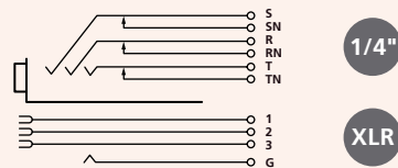
Wiring: Example of NCJ9FI-H
