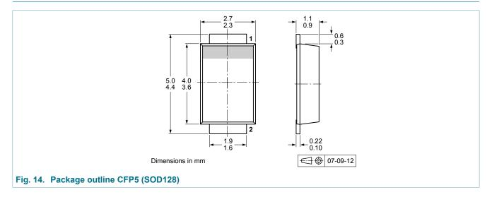
5 A low VF MEGA Schottky barrier rectifier
