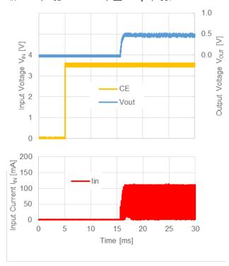
RP517x051x, Ta=25°C V<sub>IN</sub>=V<sub>CE</sub>=0V->3.6V, ⊿t=10µs, I<sub>OUT</sub>=0mA
