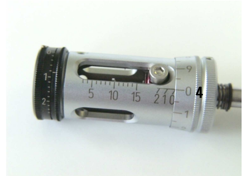
III. 23 Régler le diamètre
