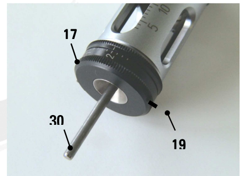
III. 24 Insérer la pige de calibrage
