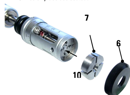
III 13 Mise en place des couteaux
