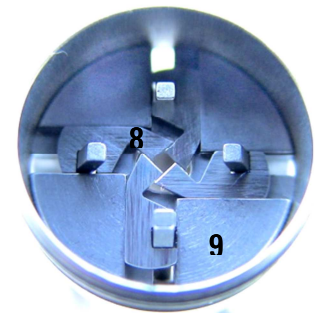
III. 11 Enlever le couvercle et la plaque de couverture
