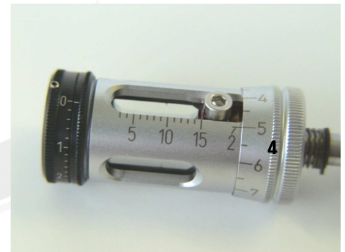
III. 16. Régler le diamètre
