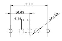
RECOMMENDED PCB LAYOUT \*TYPICAL // HOLE SIZE MAY NOT BE SUITABLE FOR YOUR SPECIFIC APPLICATION
