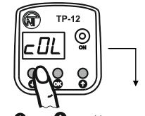
Via 🔮 or 🕥 pushbutton change the load mode value: «hOL» - Heating, «cOL» -Cooling
