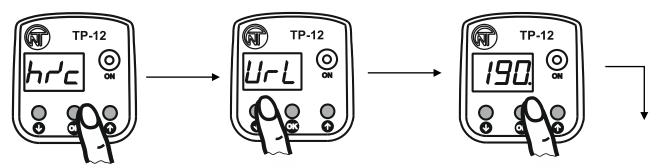
Hold **OK** pushbutton pressed for 3 seconds until the display shows «カー・c» menu parameter
