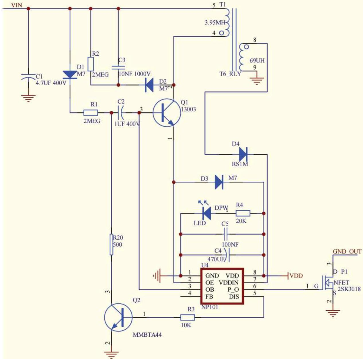
VIN 是电源输入端口，VIN 电压范围在 9V 到 310V，都可以正常工作。
