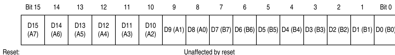
Figure 3-4. Accumulator D (D)
