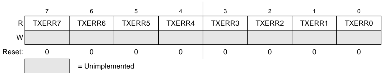
Figure 10-19. MSCAN Transmit Error Counter (CANTXERR)
