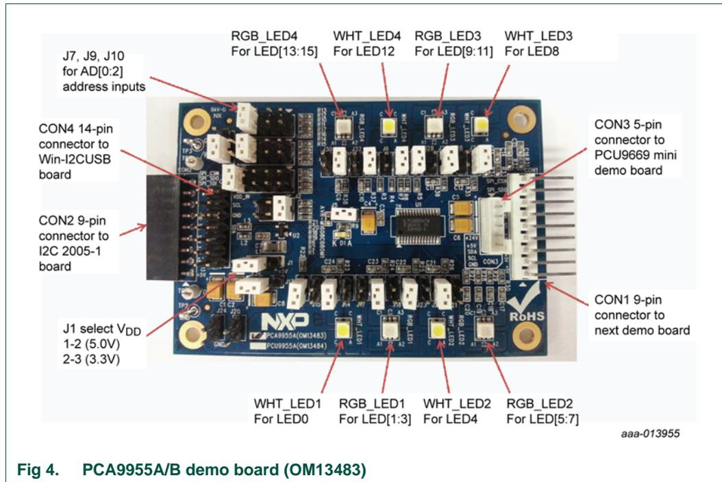
Fig 4. PCA9955A/B demo board (OM13483)
