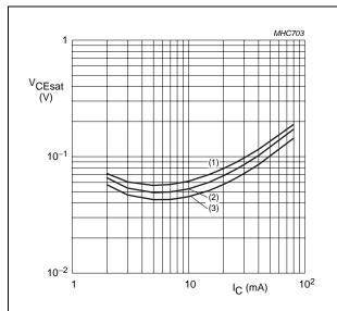
Transistor TR2;  $I_C/I_B = 20$ .
