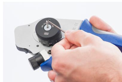
**4** Optional: Zum Einstellen den Positionierer anheben und drehen bis die gewünschte Stellung die Markierung erreicht.
