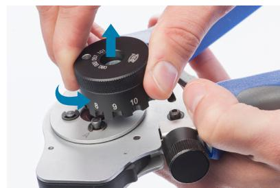
**5** Kontakt mit vorbereitetem Kabel in Crimpstelle einführen. Beachten, dass die Crimpung mittig im Crimpbereich erfolgt [optional: Kontakt vollständig eingeführt in Positionierer].
