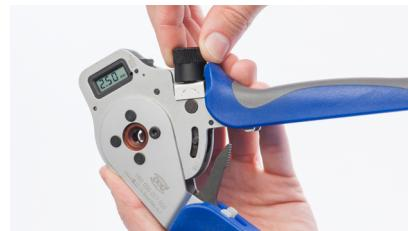
**3** Optional: Positionierer rückseitig auf vorstehende Schraube der Crimpzange setzen und mit Innensechskantschlüssel fixieren. Mit zweitem Schlüssel auf der Vorderseite gegenhalten.
