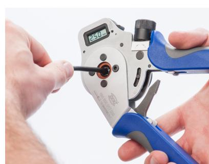
**6** Crimpzange vollständig betätigen. Nach dem Öffnen Kontakt entnehmen und das Ergebnis prüfen.
