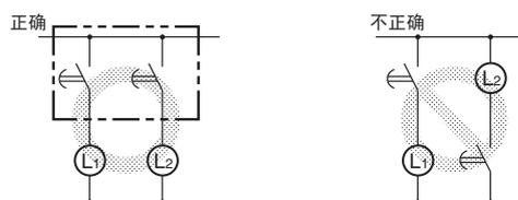
利用H3Y-C和辅助继电器（如MY继电器）共同构建自动连接或自动复位电路时，请使用以下安全的电路。
