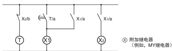
请勿按下方右手边的电路图所示的方法连接H3Y-C，否则H3Y-C的极性互不相同的内部节点可能会发生短路。
