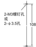
**注:** 采用螺钉安装时, 请将挂钩拉出后使用。
