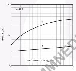
$R_L$  - LOAD RESISTANCE ( $k\Omega$ )
