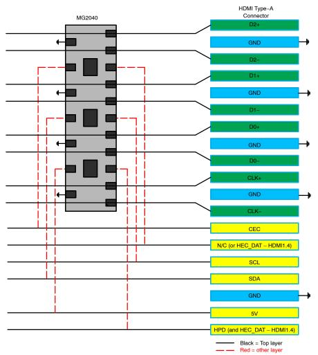
Figure 14. HDMI Layout Diagram
