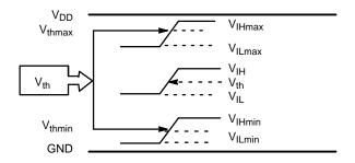
Figure 6. V<sub>th</sub> Diagram
