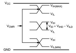
Figure 8. V<sub>CMR</sub> Diagram
