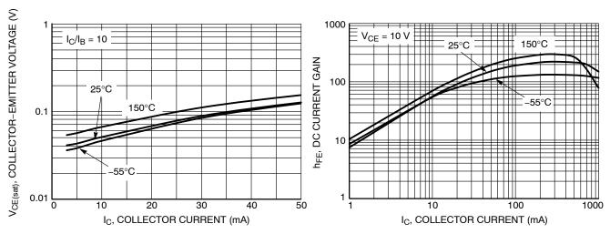
Figure 12.  $V_{\text{CE(sat)}}$  vs.  $I_{\text{C}}$
