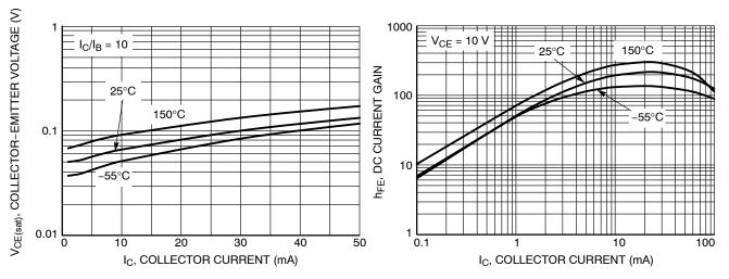
Figure 17.  $V_{\text{CE(sat)}}$  vs.  $I_{\text{C}}$
