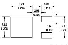
$\left(\frac{\text{mm}}{\text{inches}}\right)$ SCALE 3:1
