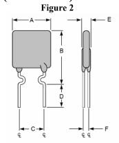
RS60SB-110 Lead Size: 20AWG, 0.81 mm Diameter
