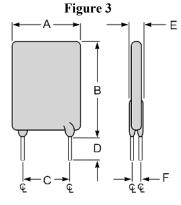
RS60SB-135 ~ RS60SB-500 Lead Size: 20AWG, 0.81 mm Diameter
