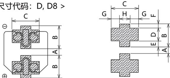
(推荐电路板焊盘尺寸)
