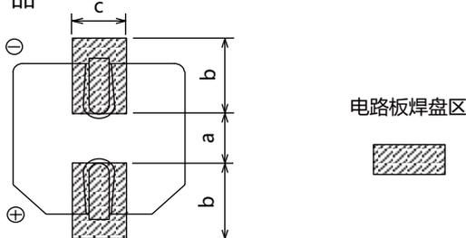
(推荐电路板焊盘尺寸)
