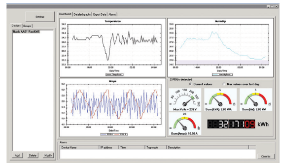
El panel despejado muestra todos los datos energéticos y ambientales como líneas de tendencia para los dispositivos seleccionados en las últimas 24 horas.
