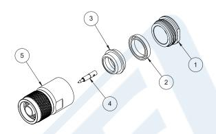
1. SLIDE CLAMP NUT ① & GASKET ② OVER CABLE. STRIP CABLE AS SHOWN. DO NOT NICK BRAID WHILE CUTTING JACKET. TAPER END OF BRAID TO PERMIT ASSEMBLY OF CLAMP.
