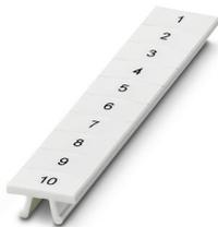
快速标记条，接头，白色，标识，适用的打印机：CMS-P1-PLOTTER，纵向打印：连续编号1 ... 10、11 ... 20等，直至491 ... 500，安装方式：已卡接，适用的模块宽度：6.2 mm，标识区域大小：6.15 x 10.5 mm，标签数：10
