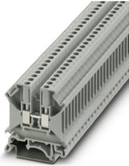
直通式接线端子，标称工作电压: 800 V，标称工作电流: 32 A，接线方式: 螺钉连接，额定接线容量:  $4 \text{ mm}^2$ ，横截面:  $0.2 \text{ mm}^2 - 6 \text{ mm}^2$ ，安装方式: NS 35/7,5，NS 35/15，NS 32，颜色: 灰色
