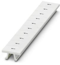
快速标记条，接头，白色，标识，适用的打印机：CMS-P1-PLOTTER，横向打印：用相同数字1或2等等，最高到100，安装方式：已卡接，适用的模块宽度：6.2 mm，标识区域大小：6.15 x 10.5 mm，标签数：10
