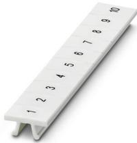
快速标记条，接头，白色，标识，适用的打印机：CMS-P1-PLOTTER，横向打印：连续编号1 ... 10、11 ... 20等，直至491 ... 500，安装方式：已卡接，适用的模块宽度：6.2 mm，标识区域大小：6.15 x 10.5 mm，标签数：10
