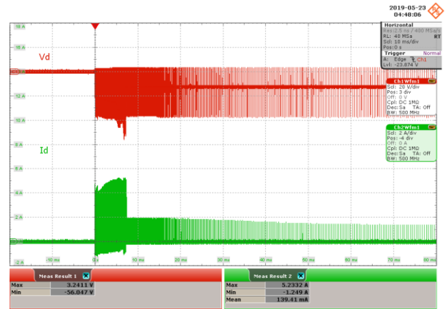
Figure 68 – 115 VAC 60 Hz. CH1: V_D , 20 V / div., 10 ms / div. CH2: I_D , 2 A / div., 10 ms / div. PIV = 56.047 V, I_{D(MAX)} = 5.2332 A.
