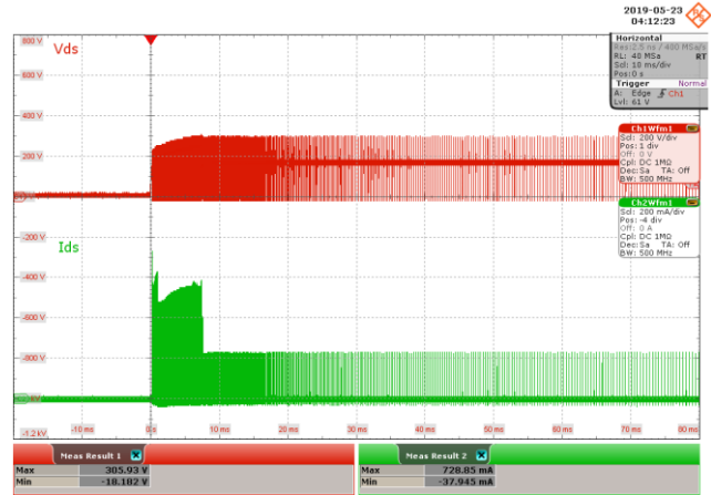
Figure 52 – 115 VAC 60 Hz. CH1: V_{DS} , 200 V / div., 10 ms / div. CH2: I_{DS} , 200 mA / div., 10 ms / div. V_{DS(MAX)} = 305.93 V, I_{DS(MAX)} = 728.85 mA.
