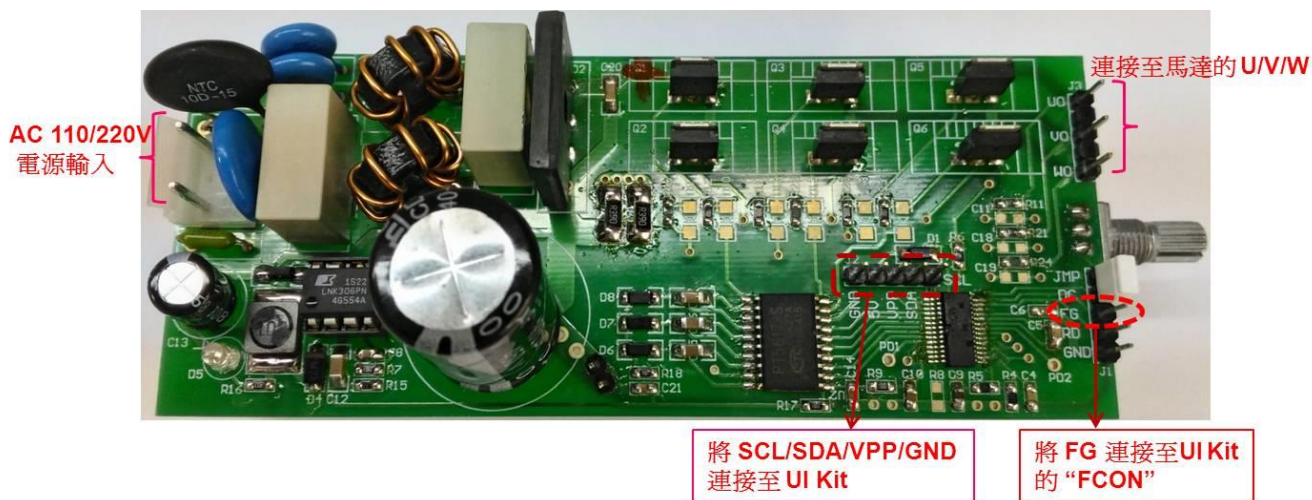
<圖 2.4 UI Kit 與 EV Board 的連接>
