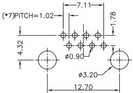
PC BOARD LAYOUT T=1.60mm COMPONENT SIDE SHOWN TOLERANCES±0.05mm
