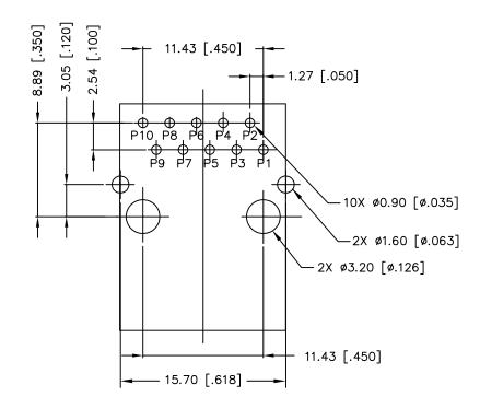
RECOMMENDED PWB LAYOUT (COMPONENT SIDE SHOWN)
