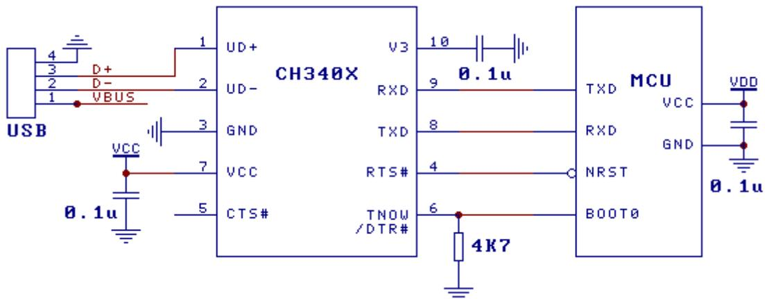
上图是基于 USB 转串口的多模式 MCU 一键下载参考电路, 无需手工设置或手动复位。
