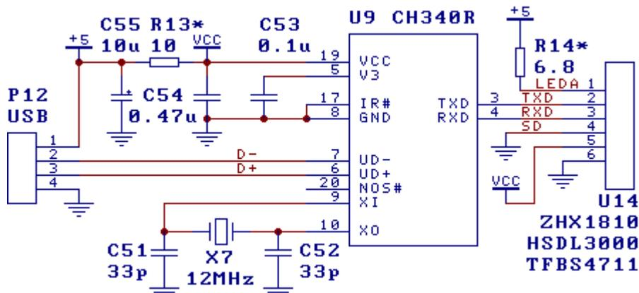
上图是由 USB 转 IrDA 红外芯片 CH340R 和红外线收发器 U14 (ZHX1810/HSDL3000 等类似型号) 构成的 USB 红外线适配器。电阻 R13 用于减弱红外线发送过程中的大电流对其它电路的影响, 要求不高时可以去掉。限流电阻 R14 应该根据实际选用的红外线收发器 U14 的厂家的推荐值进行调整。
