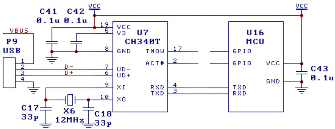
图中是统一供电方式下 MCU 单片机通过 TTL 串口连接 CH340 芯片实现 USB 通讯的参考电路。该产品选择自供电方式, VCC 支持 5V 或者 3.3V (VCC 为 3.3V 时 V3 需短接到 VCC), 完全不使用 USB 总线电源 VBUS (如有需要 MCU 可以通过 I/O 串电阻后检测其是否有效)。CH340 与 MCU 使用同一电源 VCC, 所以 CH340 与 MCU 之间不存在双电源通过 I/O 相互电流倒灌的情形。
