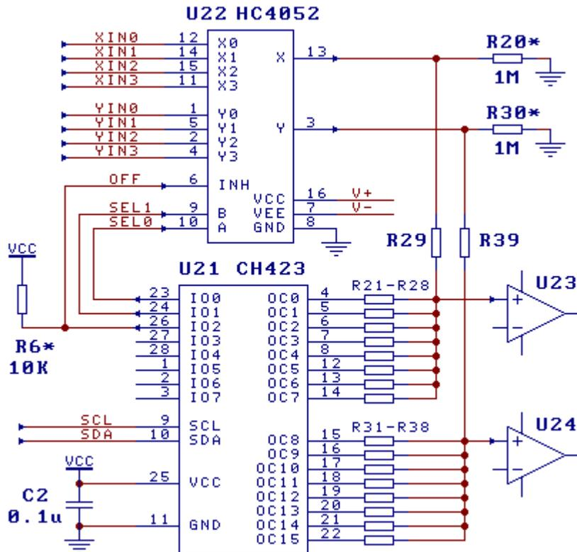
CH423 的 OC 引脚在开漏输出方式下是低阻开漏输出，导通电阻小于 10 欧姆，可以用作一端接地
