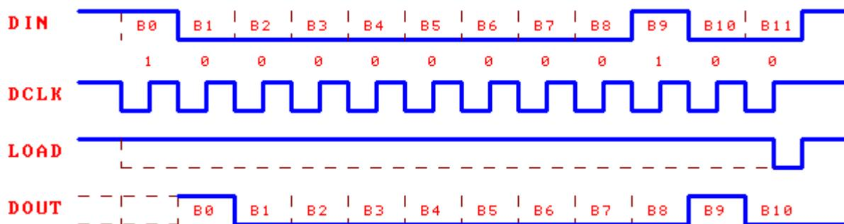
上图是在未启用键盘扫描功能时，单片机通过串行接口向 CH451 发送 12 位数据的波形示意图，数据是 00100000001B，LOAD 的低电平脉冲可以更宽，图中以虚线表示。
