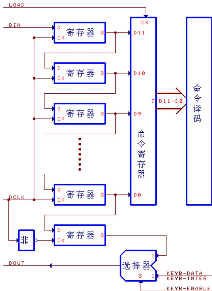
CH451 具有硬件实现的高速 4 线串行接口，包括 4 个信号线：串行数据输入线 DIN、串行数据时钟线 DCLK、串行数据加载线 LOAD、串行数据输出线 DOUT。其中，DIN、DCLK、LOAD 是带上拉的输入信号线，默认是高电平；DOUT 在未启用键盘扫描功能时作为串行数据输出线，在启用键盘扫描功能后作为键盘中断和数据输出线，默认是高电平。
