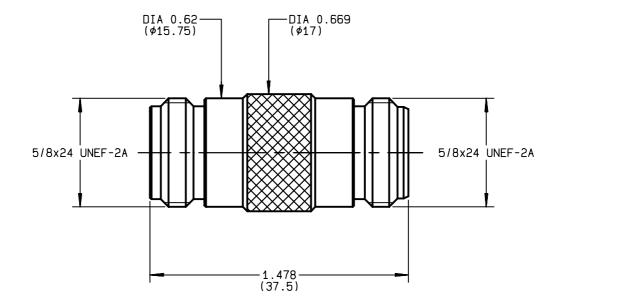
NOMINAL IMPEDANCE **50** Ω **0-11** GHz FREQUENCY RANGE **-55/+155** °C TEMPERATURE RATING V.S.W.R 1.30 + x F(GHz)Maxi 0.048 √F(GHz) dB Maxi RF INSERTION LOSS 1400 Veff Maxi **VOLTAGE RATING** DIELECTRIC WITHSTANDING VOLTAGE 2500 Veff Mini
