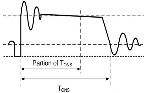
通过在辅助线圈与 FB 之间设置电阻分压电路，辅助线圈的电压在每个消磁阶段将结束的时候被采样，并且采样电压会被保持，直到下一个采样周期。采样电压与内部误差放大器的参考电压 2V 进行比较，它们之间的误差将被放大。误差放大器的输出反映了负载情况，其电压决定系统开关频率，通过这样一个闭环控制，RM3368SL 实现了输出恒压控制。当采样电压低于 2V，误差放大器输出达到最大值，芯片进入恒流控制状态，开关频率直接由 FB 脚采样电压决定，实现了输出恒流控制。
