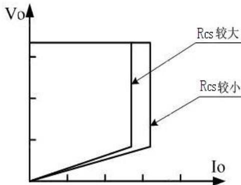
RM3368SL 内部设有 OCP 补偿模块，可以有效的减小恒流模式输出电流的变化，OCP 阈值在不同的 AC 输入电压下通过斜率补偿曲线可以自动调节。如下图 4，不同的导通时间下，OCP 阈值电压的变化曲线。在 1.8~3.7uS 之间，OCP 阈值在 500mV~555mV 之间线性变化。小于 1.8uS，OCP 阈值为 500mV，大于 3.7uS，OCP 阈值为 555mV。
