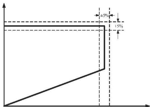
图 1 典型的 CC / CV 曲线在充电器应用中，未充电的电池首先在恒流状态下进行充电，当电池将要充满时，充电阶段会转换为恒压模式。在电源适配器的应用中，系统工作于恒压状态。
