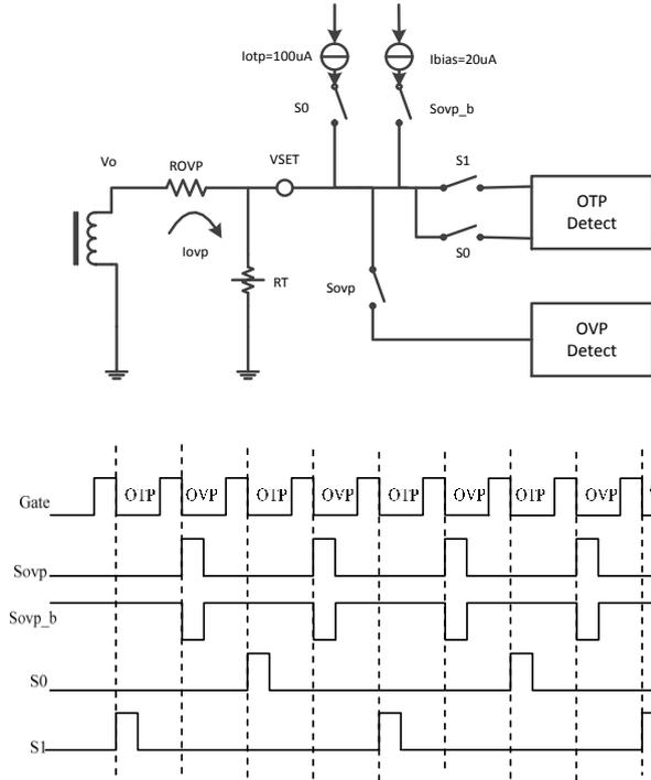
外部 OTP 和输出 OVP 的双重功能，通过 NTC 电阻和输出 OVP 功能，对外部 OTP 的检测变得可行和准确。双功能通过分时处理实现，如图所示。
