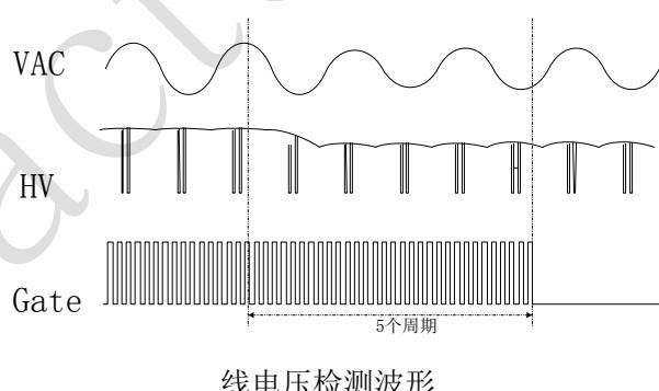
通过修改 HV 脚限流电阻阻值，可调节“Brown-in”及“Brown-out”检测电流，从而修改对应“Brown-in”及“Brown-out”电压限值。
