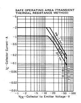
COLLECTOR CURRENT vs. COLLECTOR TO EMITTER VOLTAGE
