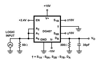
FIGURE 3B. DG407 TEST CIRCUIT
