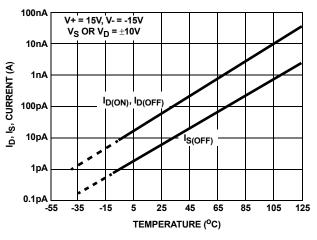
FIGURE 10. I<sub>D</sub>, I<sub>S</sub> LEAKAGE vs TEMPERATURE
