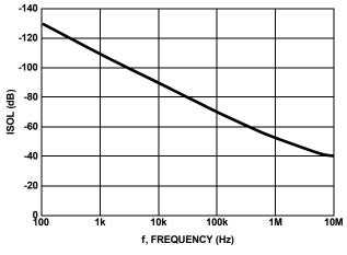
FIGURE 13. OFF-ISOLATION vs FREQUENCY
