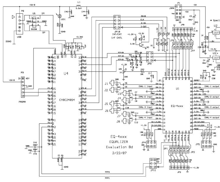
FIGURE 11. SCHEMATIC OF THE QLX4600-S30 EVALUATION BOARD
