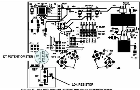
FIGURE 6. QLX4600-S30 EVALUATION BOARD DT POTENTIOMETER
