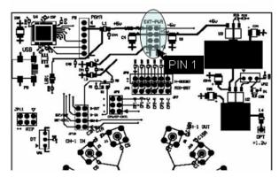
FIGURE 4. QLX4600-S30 EVALUATION BOARD EXTERNAL POWER SUPPLY POWER CONNECTOR
