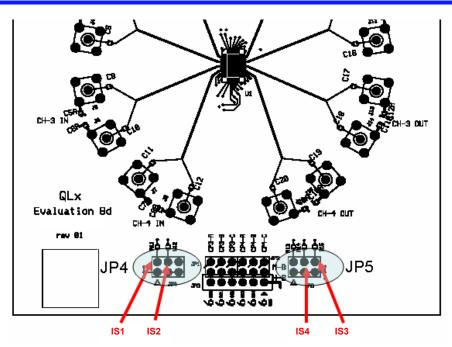
FIGURE 7. QLX4600-S30 EVALUATION BOARD IMPEDANCE SELECT
