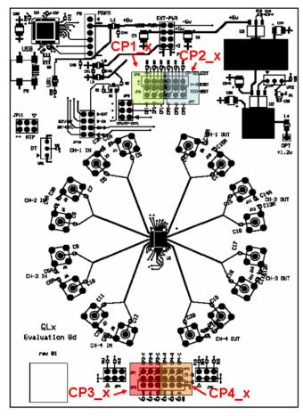
FIGURE 8. EQUALIZER BOOST CONTROL HEADERS
