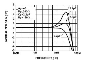
FIGURE 5. GAIN vs FREQUENCY FOR VARIOUS  $C_{IN}$  (-)
