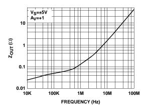
FIGURE 12. Z<sub>OUT</sub> vs FREQUENCY
