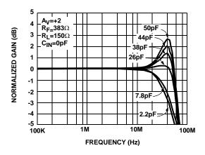
FIGURE 24. GAIN vs FREQUENCY FOR VARIOUS CL
