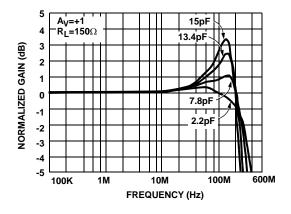
FIGURE 21. GAIN vs FREQUENCY FOR VARIOUS CL
