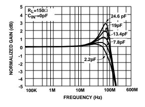
FIGURE 22. GAIN vs FREQUENCY FOR VARIOUS CL
