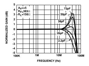
FIGURE 23. GAIN vs FREQUENCY FOR VARIOUS CL
