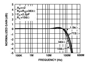
FIGURE 9. GAIN vs FREQUENCY FOR VARIOUS  $R_{\rm L}$
