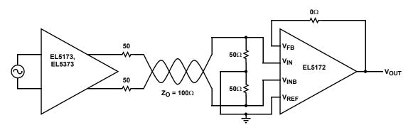
FIGURE 24. TWISTED PAIR CABLE RECEIVER
