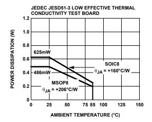
FIGURE 20. PACKAGE POWER DISSIPATION vs AMBIENT TEMPERATURE
