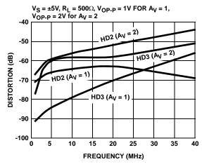
FIGURE 16. HARMONIC DISTORTION vs FREQUENCY
