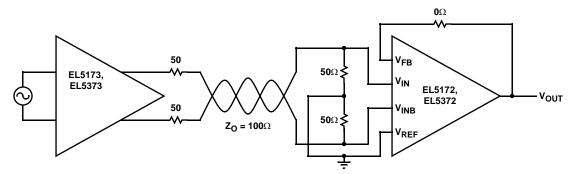
FIGURE 25. TWISTED PAIR CABLE RECEIVER
