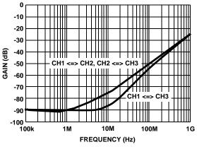
FIGURE 13. CHANNEL ISOLATION vs FREQUENCY
