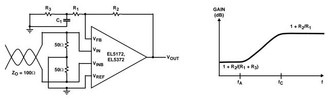
FIGURE 26. COMPENSATED LINE RECEIVER
